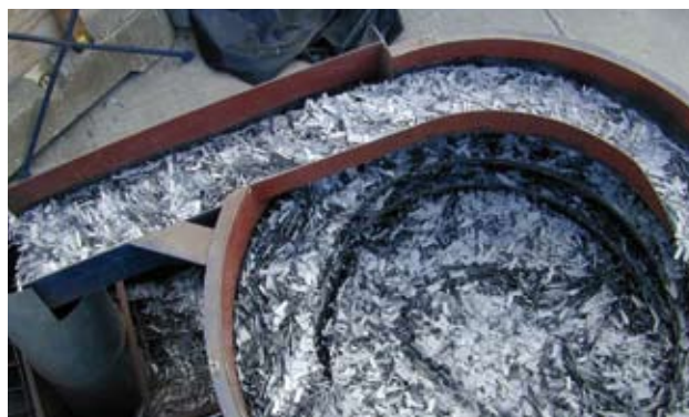
Stålfibre doseres i fabriksblander via big bags og automatisk doseringsanlæg.
