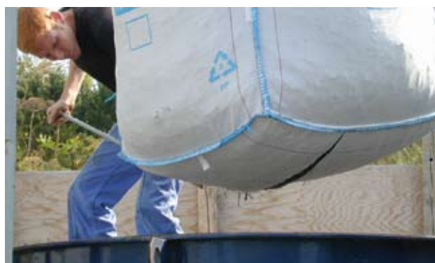
Stålfibre doseres i fabriksblander via big bags og automatisk doseringsanlæg.
