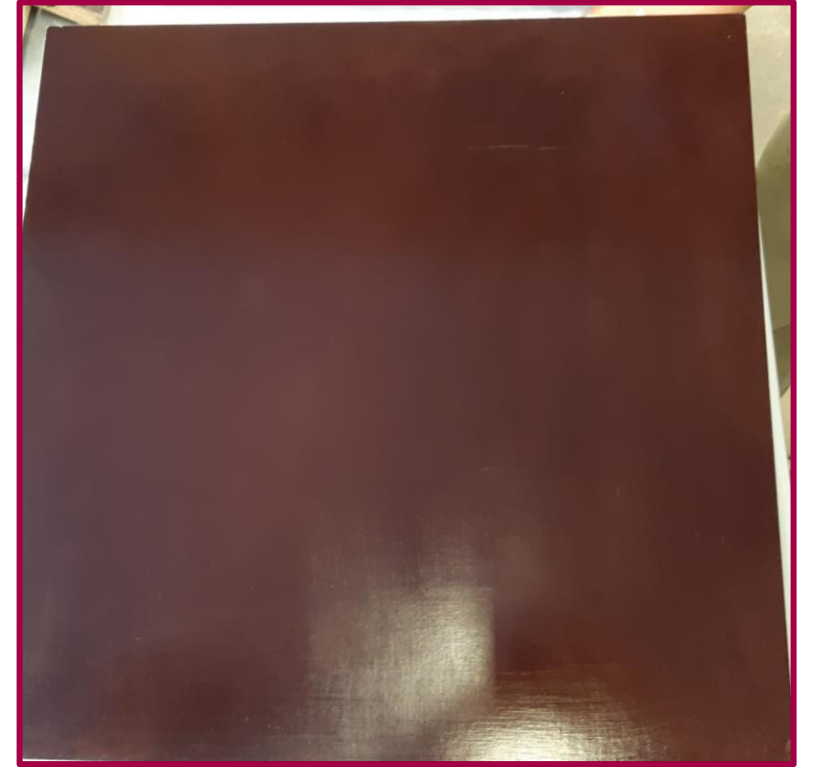
1½ time efter påførelse og aftørring af formolie ( tyndt lag )
