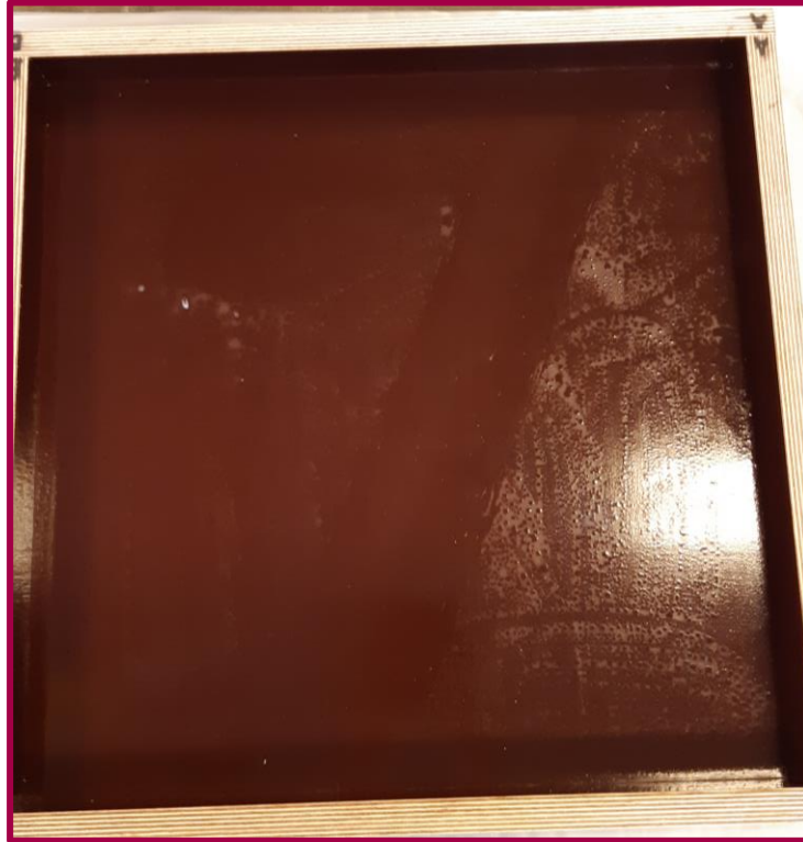
1½ time efter påførelse af formolie ( tykt lag )
